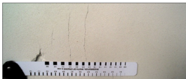
Pomiar szerokości rys po badaniu w komorze klimatycznej za pomocą szczelinomierza po wydłużonym procesie starzenia Fot. SSO
